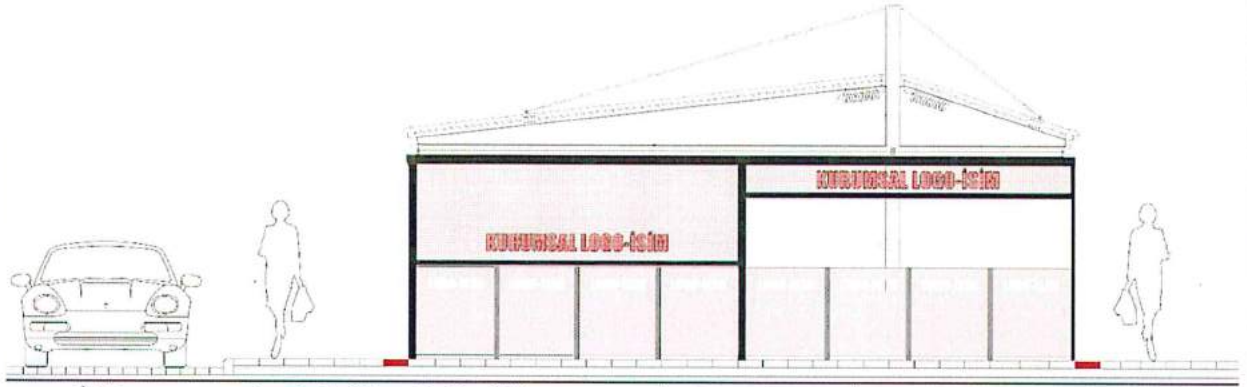
İşletme yan cephesinde "Kanallı Profil" cam tutuculu separatör uygulaması
